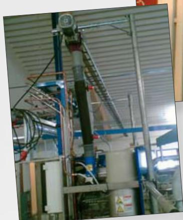
Сpirальный транспортер HD заполняет кормовую станцию молочного робота
